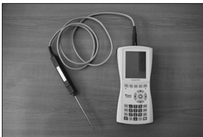
Obr. 44 Prístroj Isomet 2114 s ihlovou sondou (Foto: Trník, 2013)
