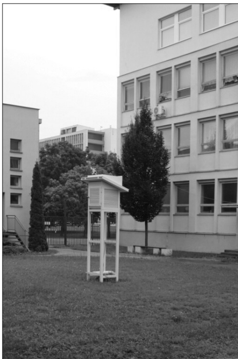
Obr. 14 Meteostanica 1, otvorené, oslnené stanovište (Foto: Klein, 2012)
